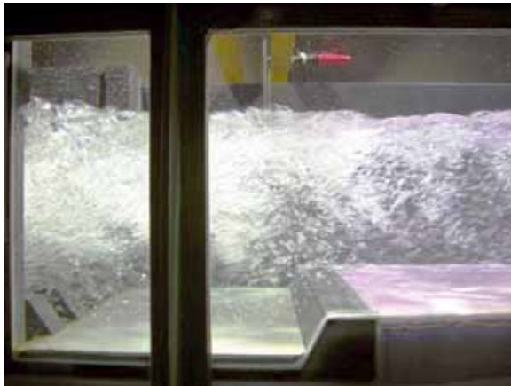
Hydraulischer Modellversuch mit saniertem Tosbecken (links), Spundwandaarbeiten in der Wehröffnung Nr. 3 (rechts)
